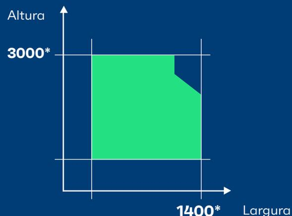
\*As dimensões máximas dependem de múltiplos parâmetros, incluindo requisitos de resistência à carga do vento e escolha do tipo de vidro.
